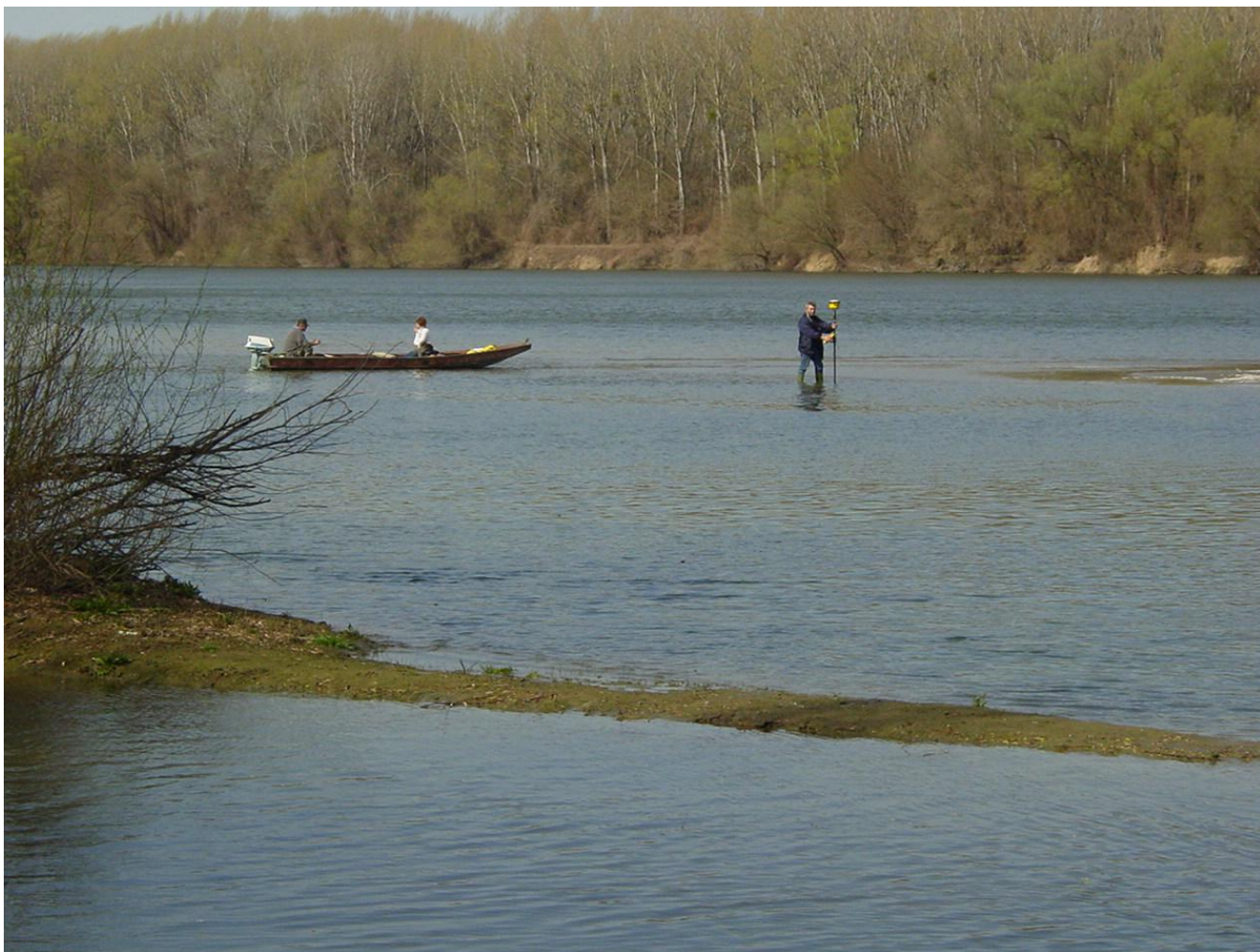
na dubinama ispod 0.5 metara mjeri se direktno bez echo-soundera
