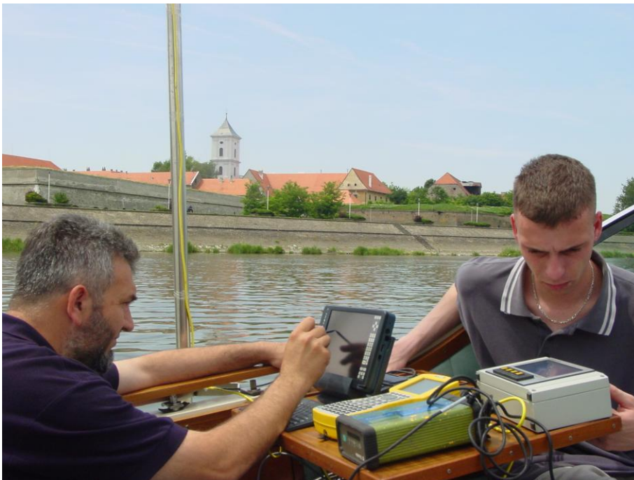
Detalj mjerenja na rijeci Dravi (računalo, GPS, echo-sounder)
